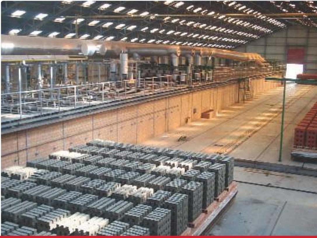
briques. C'est autour de cette température que se produit le «point de quartz» : il s'agit de la température à laquelle la structure cristalline du quartz est modifiée. A cette étape de la cuisson, les briques sont très sensibles à la formation de fissures.
