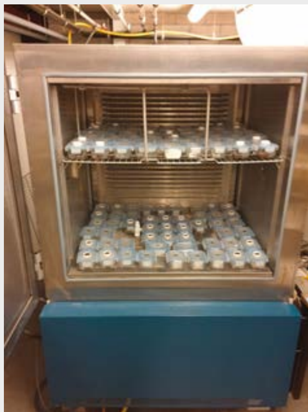
Une chambre climatique remplie de configurations ATM (C)
