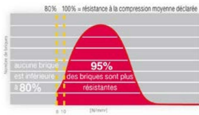
Figure 3 : Résistance moyenne (européenne) à la compression  $f_{mean}$
